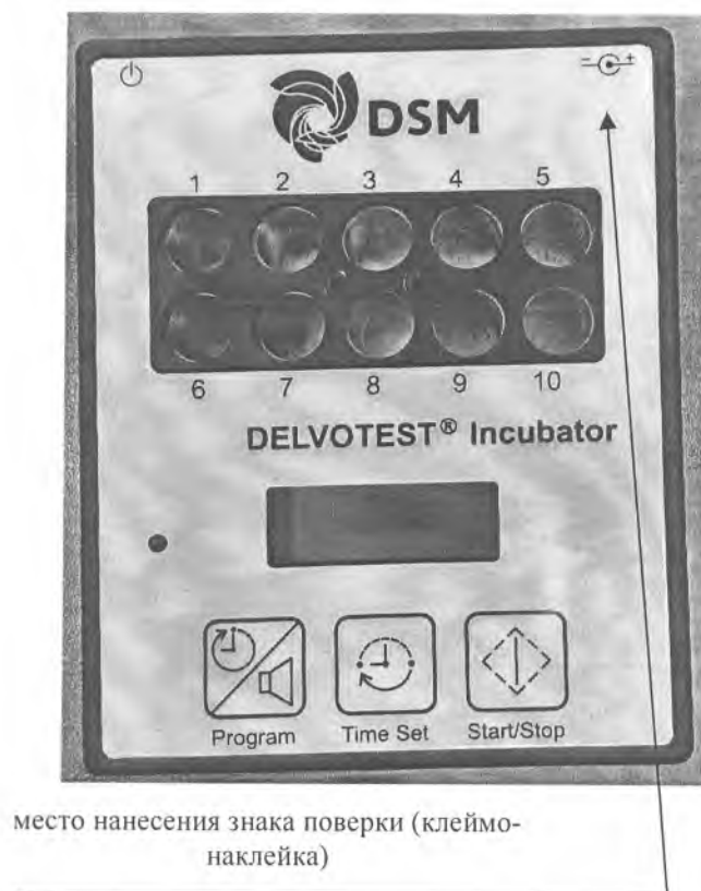
Рисунок А.1 – Место нанесения знака поверки (клеймо-наклейка) на термостат-инкубатор MCI 212 (модификация MCI 212 DUAL)
