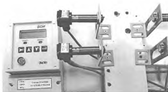
Рисунок 1 – Внешний вид счетчиков электронных оптических перемещающихся объектов УСБ (а – УСБ-5/9504, б – УСБ-5/534, в – УСБ-5/9202)
