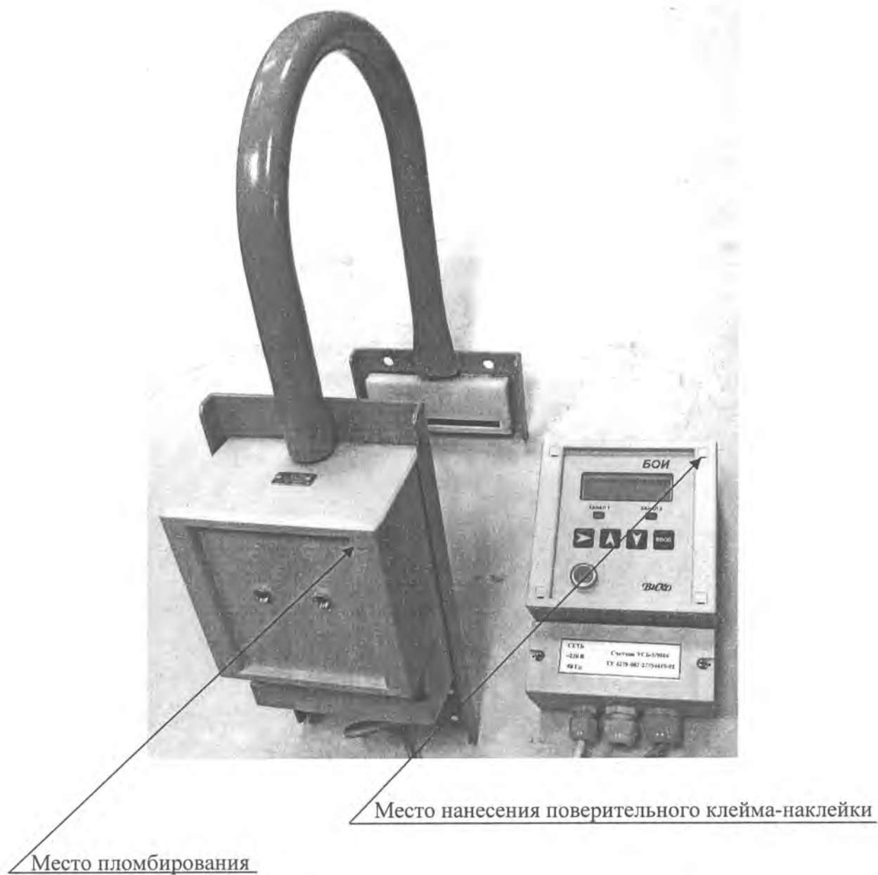
Рисунок А.1 – Схема с указанием мест нанесения поверительного клейма-наклейки и пломбировки
