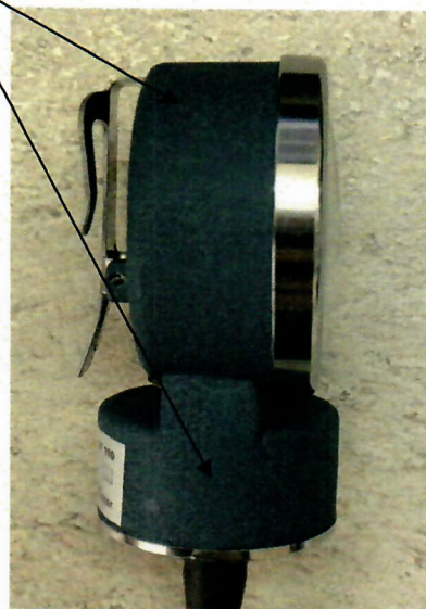
Рисунок 1.А – Место нанесения знака поверки (клеймо-наклейка) для измерителей iMed GT 110
