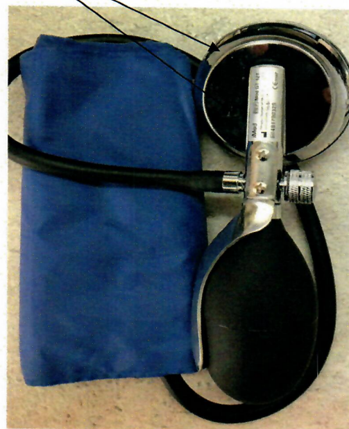
Рисунок 2.А – Место нанесения знака поверки (клеймо-наклейка) для измерителей iMed GT 121
