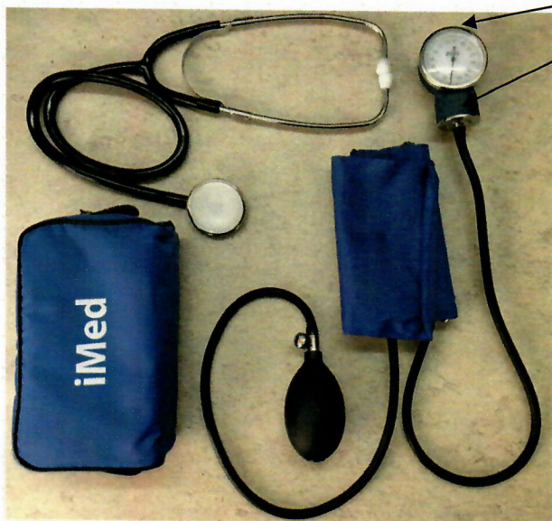
Рисунок 1.А – Место нанесения знака поверки (клеймо-наклейка) для измерителей iMed GT 110
