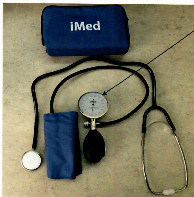
Рисунок 2.А – Место нанесения знака поверки (клеймо-наклейка) для измерителей iMed GT 121
