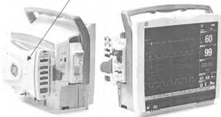
Рисунок А.2— Место нанесения знака поверки в виде клейма-наклейки на мониторы пациента модульные серии Carescape (модификация Carescape B450)
