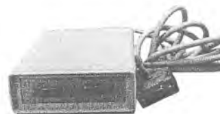
Датчик реографический (ДР) «Валента»
