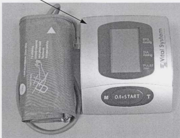
Рисунок 3 – Место нанесения знака поверки (клеймо-наклейка) на измеритель КР6920 (PBG-902)
