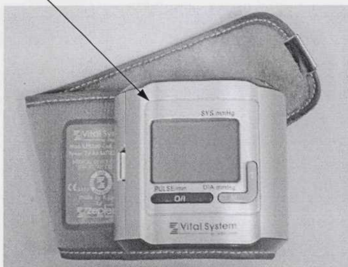
Рисунок 4 – Место нанесения знака поверки (клеймо-наклейка) на измеритель КР6240 (PBG-903)
