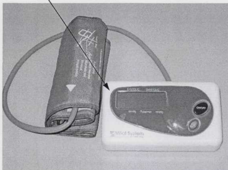
Рисунок 1 – Место нанесения знака поверки (клеймо-наклейка) на измеритель КР6821 (PBG-829)
