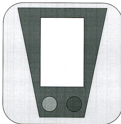
Рисунок 1.А. Место нанесения клейма-наклейки государственного поверителя для модификации КР 6130 (PBG-831).
