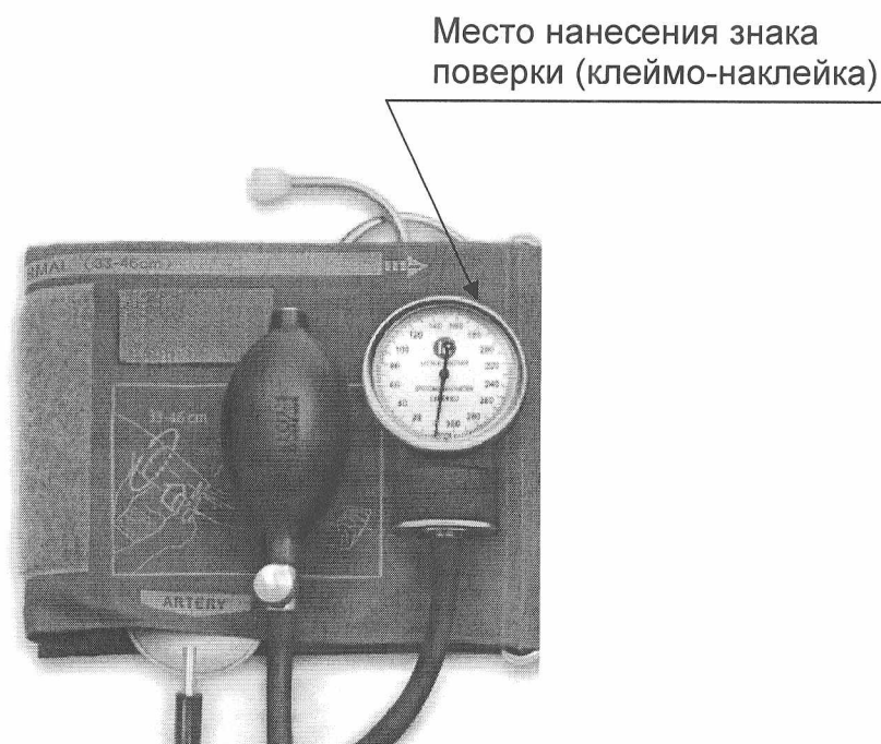
Рисунок 2.А – Место нанесения знака поверки (клеймо-наклейка) LD-60, LD-61, LD-70, LD-70NR, LD-71, LD-71A, LD-100
