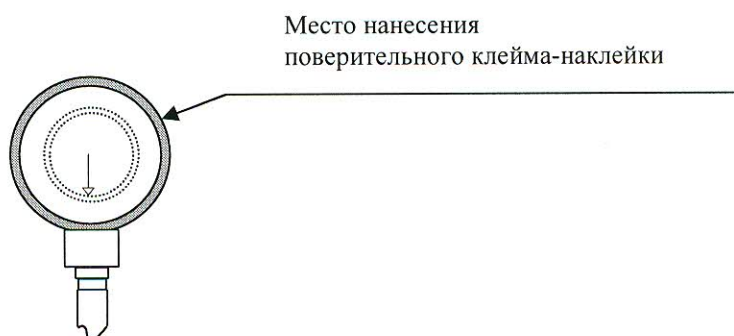
Рис.1.А Место нанесения поверительного клейма-наклейки для измерителей LD-80, LD-81, LD-90, LD-91
