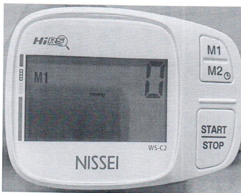
Рисунок 6 – Прибор для измерения артериального давления и частоты пульса цифровой WS-C2
