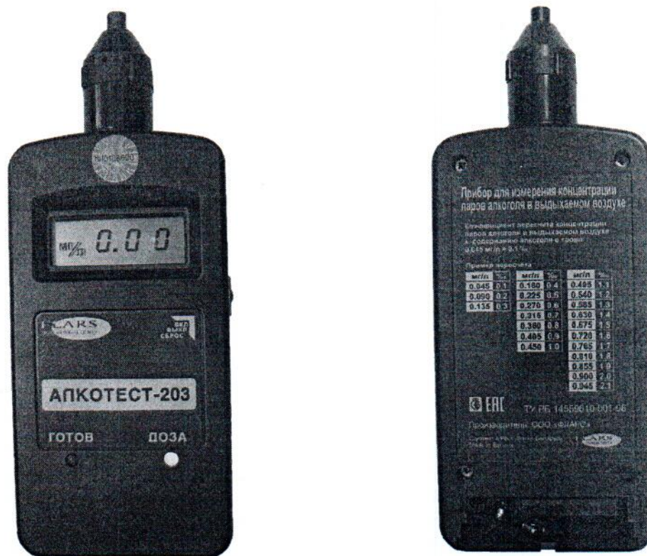
Рисунок 1. Внешний вид прибора для измерения концентрации паров алкоголя в выдыхаемом воздухе «АЛКОТЕСТ-203»
