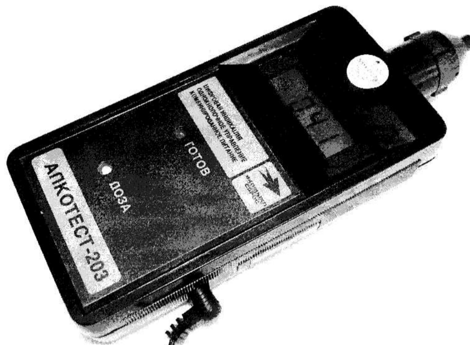
Рис. 1А. Прибор «Алкотест-203» (верхняя панель)
