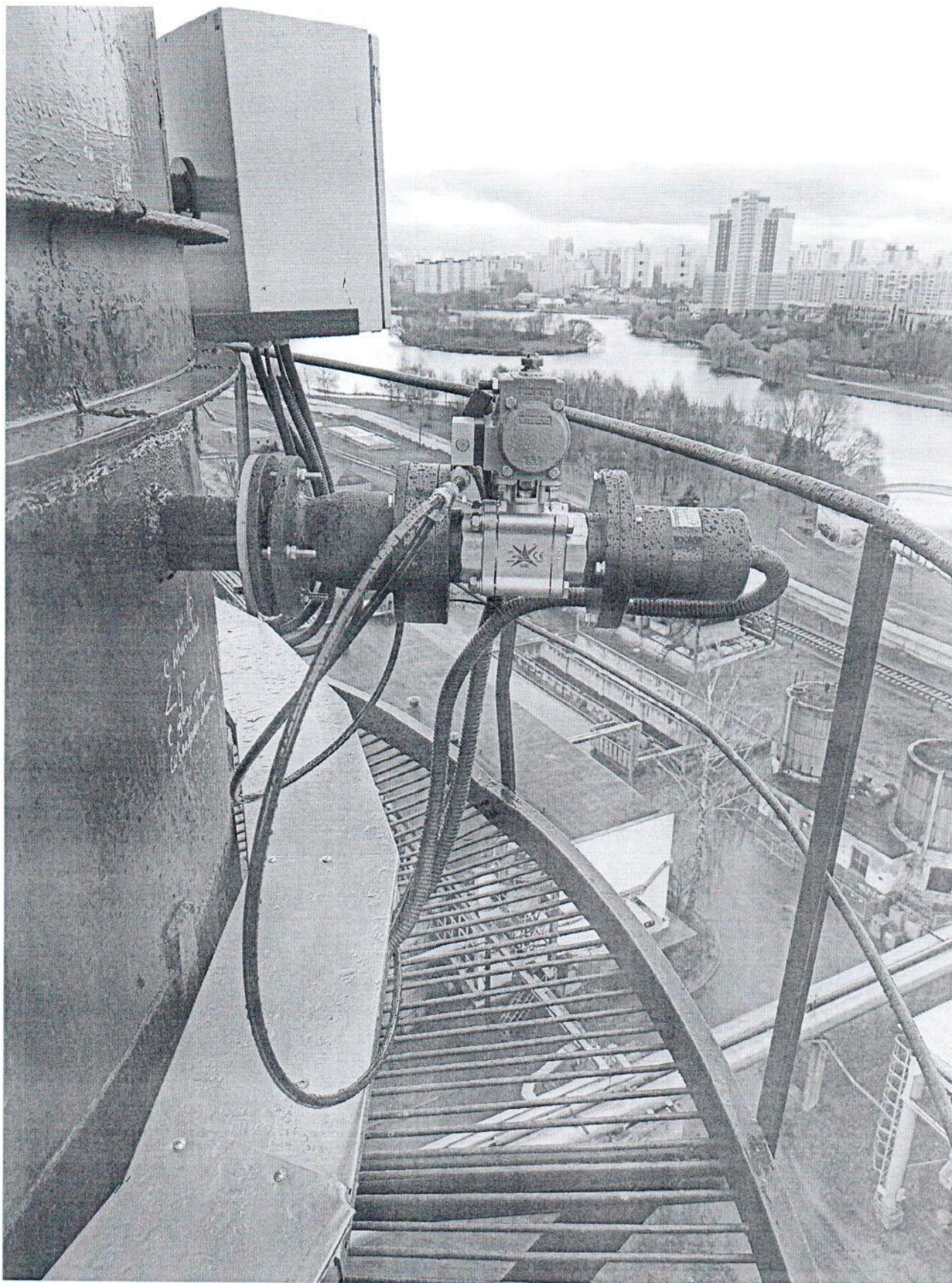
Рисунок 1.9 – Фотография общего вида дымовой трубы. Анализатор пыли DCEM2100
