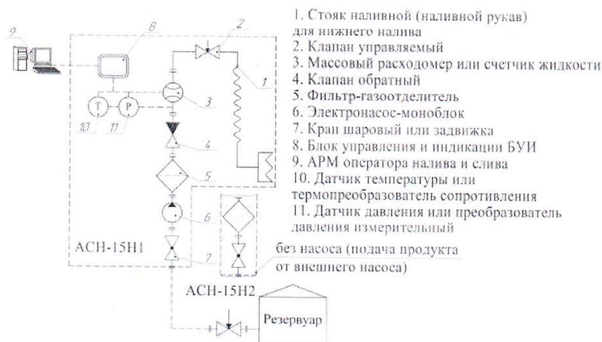
Рисунок 3 – Система измерительная нижнего налива: АСН-15Н1 (с насосом), АСН-15Н2 (без насоса). Измерительная схема
