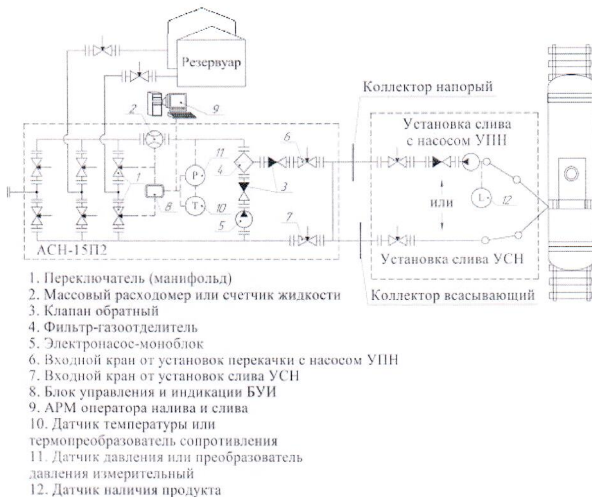
Рисунок 8 – Система измерительная для приёмки и перекачки продукта от ЖД цистерн в резервуары (групповой/поколлекторный учет) и между резервуарами АСН-15П2. Измерительная схема
