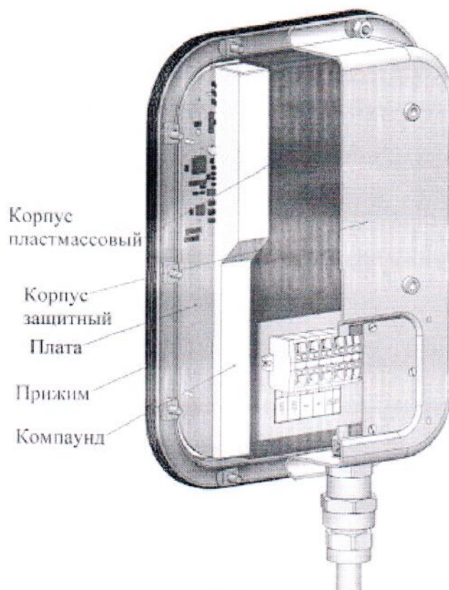
Рисунок 10 – Схема пломбировки БУИ от несанкционированного доступа
