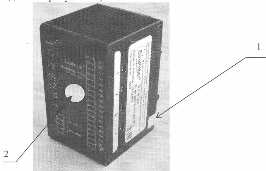
1 – место нанесения пломбы-этикетки, обеспечивающей защиту от несанкционированного доступа;
