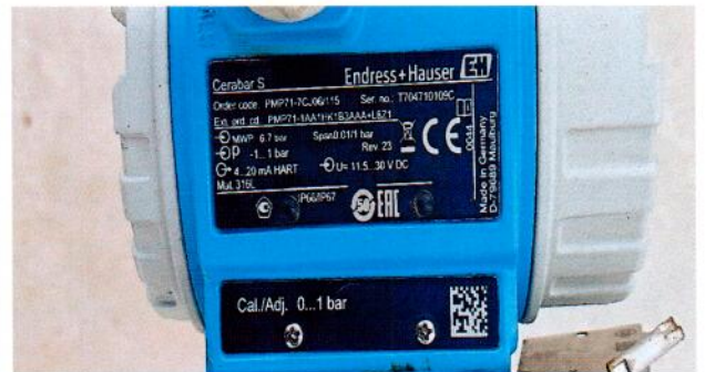
Рисунок 1.6 – Внешний вид и образец маркировки преобразователя гидростатического давления из состава системы (изображения носят иллюстративный характер)
