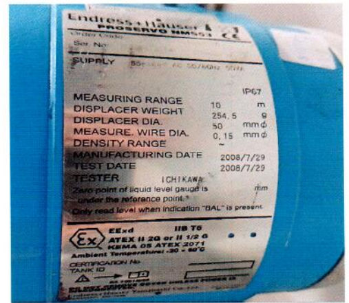
Рисунок 1.4 – Внешний вид и образец маркировки уровнемера Proservo из состава системы (изображения носят иллюстративный характер)
