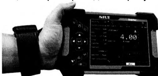
Рисунок 1 – Общий вид толщиномера ультразвукового Smartor
