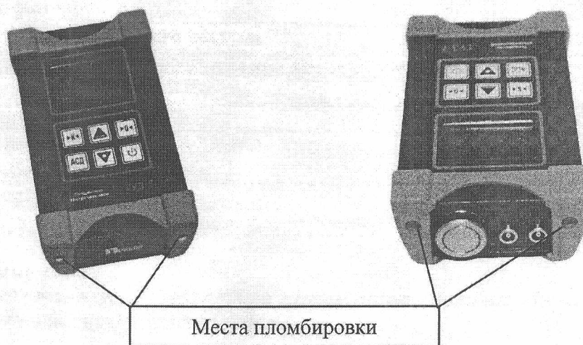
Рисунок 2 - Схема пломбировки от несанкционированного доступа
