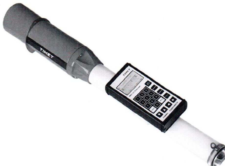
Рисунок 1 – Внешний вид радиометра-дозиметра МКС-01М "Советник"
