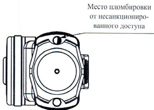
Рисунок 3.1 – Схема пломбировки от несанкционированного доступа
