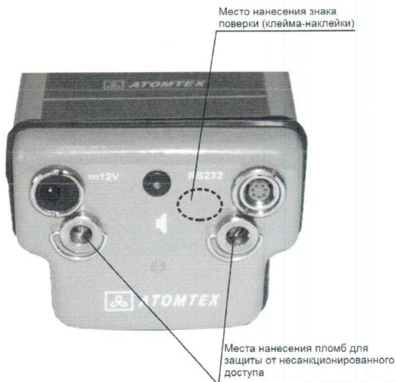
Рисунок 2 – Место нанесения знака поверки (клейма-наклейки) и места нанесения пломб для защиты от несанкционированного доступа
