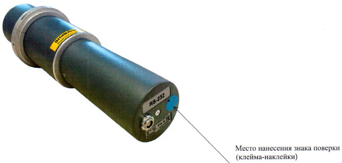
Рисунок 2.1 – Схема (рисунок) с указанием места для нанесения знака поверки средств измерений на блоке детектирования гамма-излучения БДКГ-11С из состава радиометра
