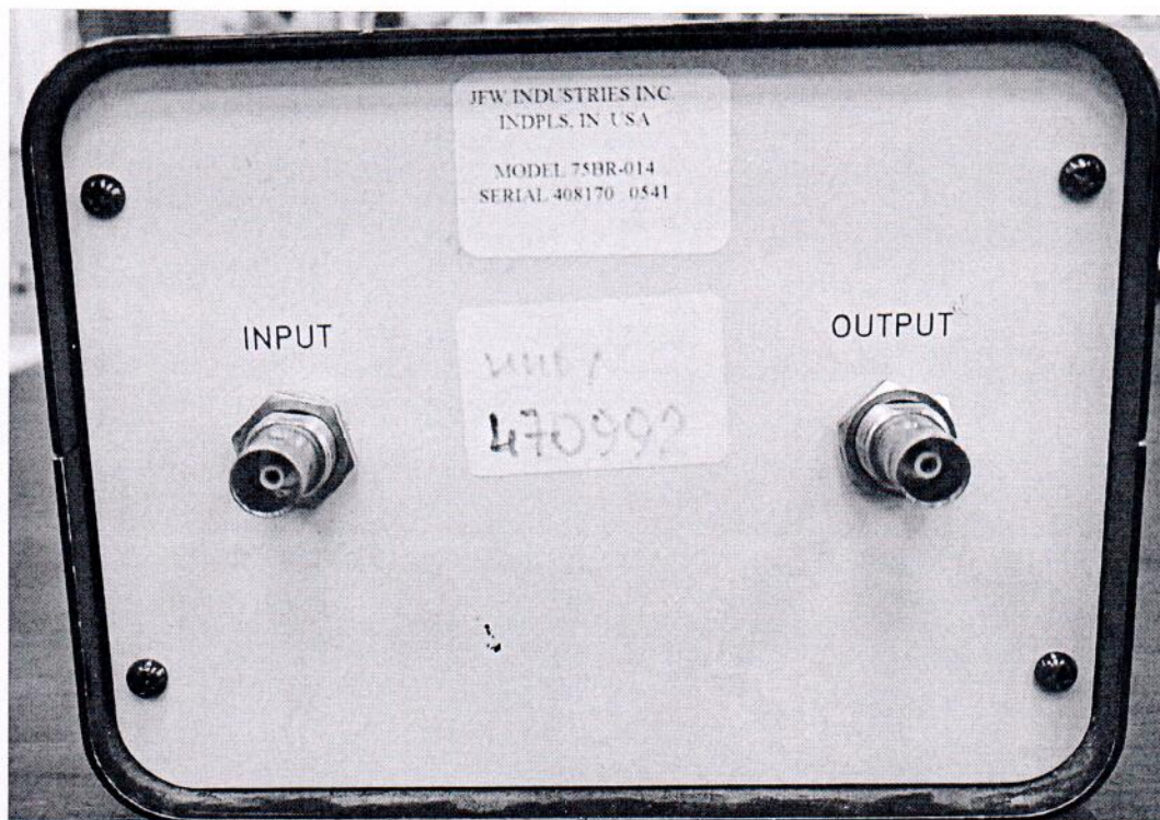
Рисунок 1.2 – Фотография общего вида задней панели аттенуатора 75BR-014 № 408170 0541
