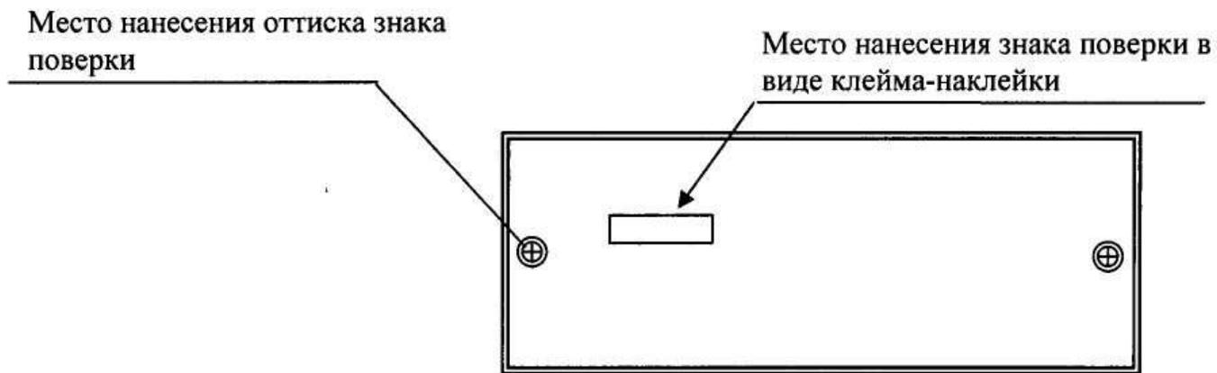
Рисунок А.1 – Место нанесения оттиска знака поверки и знака поверки в виде клейма-наклейки (вид генератора сзади)
