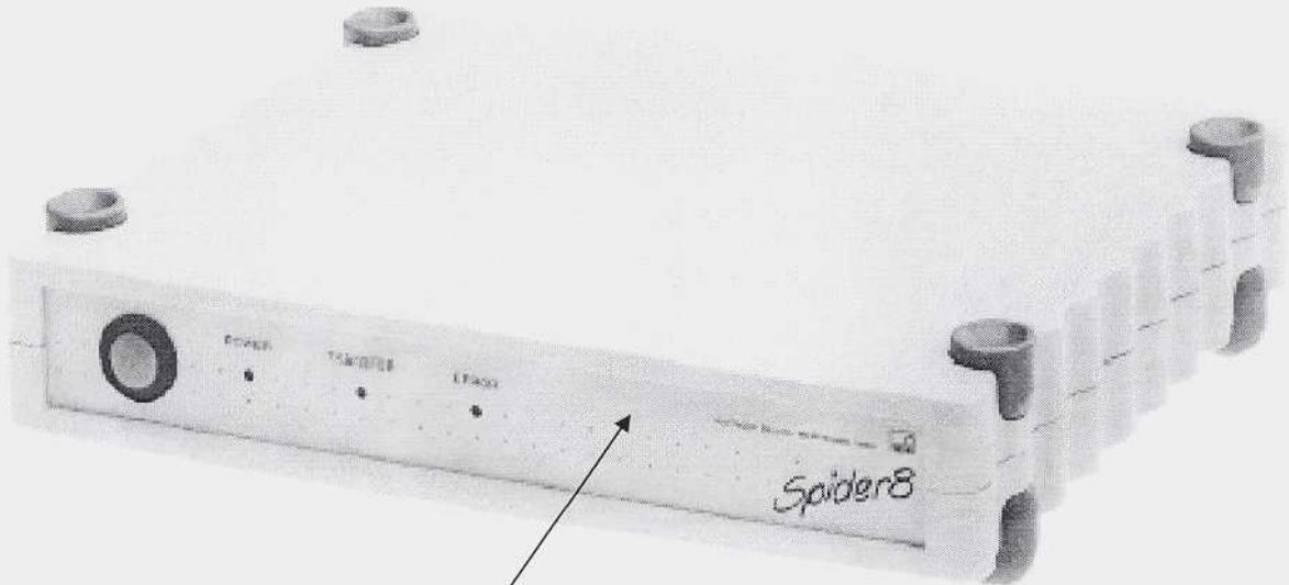
Место нанесения знака поверки в виде клейма-наклейки
