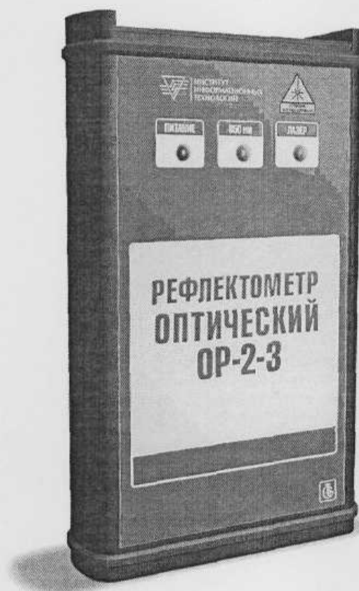
Рисунок 1. Внешний вид рефлектометра ОР-2-3
