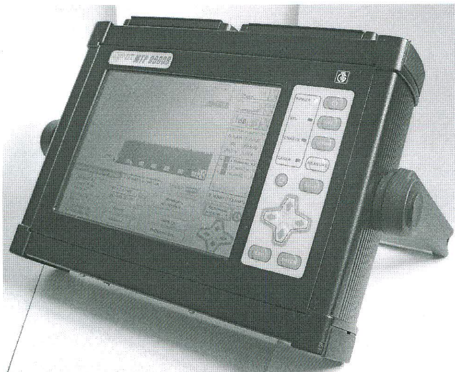
Рисунок 3. Внешний вид прибора оптического измерительного многофункционального МТР 9000В
