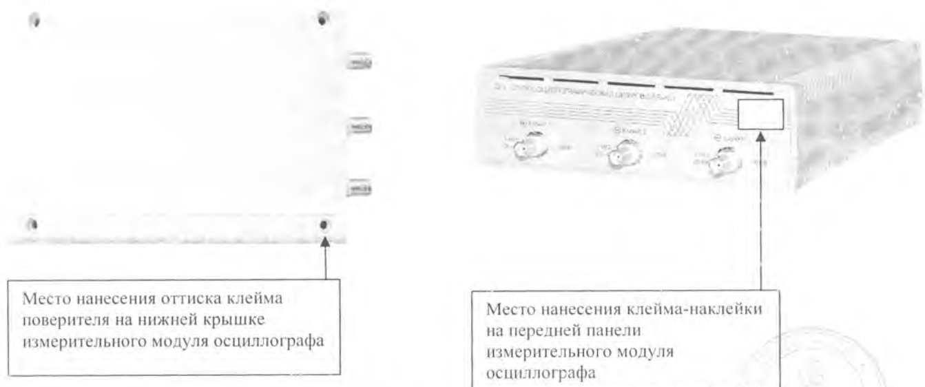
Рисунок А.3 – Схема пломбирования осциллографов В-423, В-424
