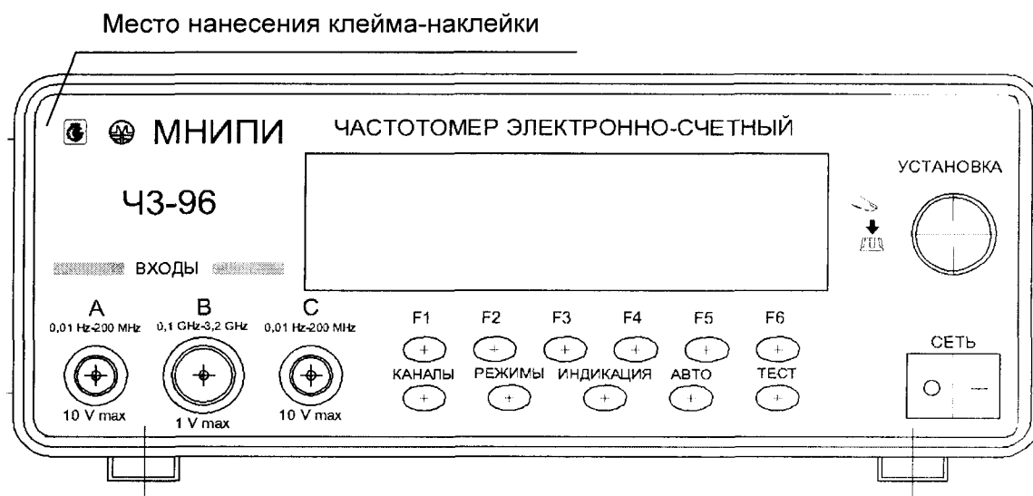
Рисунок А.2 – Место нанесения клейма-наклейки (лицевая панель частотомера)
