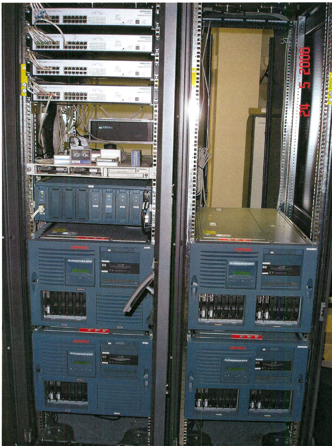
Рисунок 1 – Внешний вид системы повременного учета длительности соединений автоматизированной АПУС ИС Alcatel 8690 OSP
