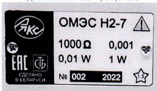
д) Мера электрического сопротивления однозначная H2-7, 1 кОм
