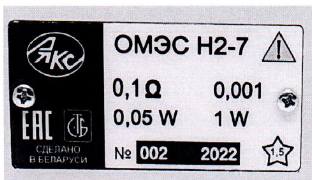
а) Мера электрического сопротивления однозначная H2-7, 0,1 Ом
