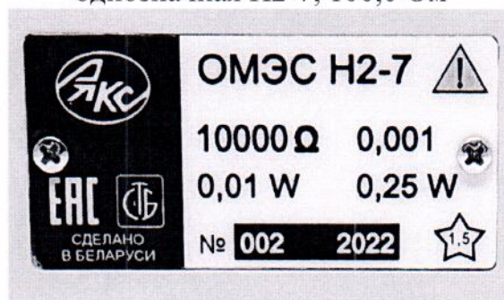
е) Мера электрического сопротивления однозначная H2-7, 10 кОм
