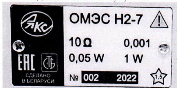
в) Мера электрического сопротивления однозначная H2-7, 10,0 Ом
