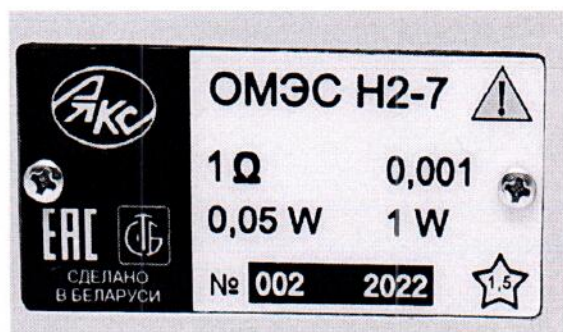
б) Мера электрического сопротивления однозначная H2-7, 1,0 Ом
