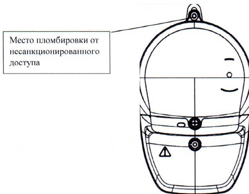
Рисунок 3.3 - Схема (рисунок) с указанием места пломбировки от несанкционированного доступа на счетчик CE208BY S51, S52/x, S53
