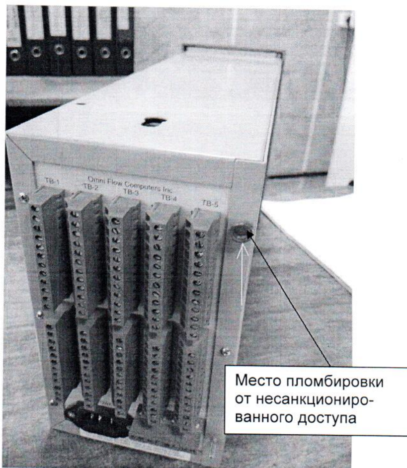
Рисунок 3.2 – Место пломбировки на задней поверхности
