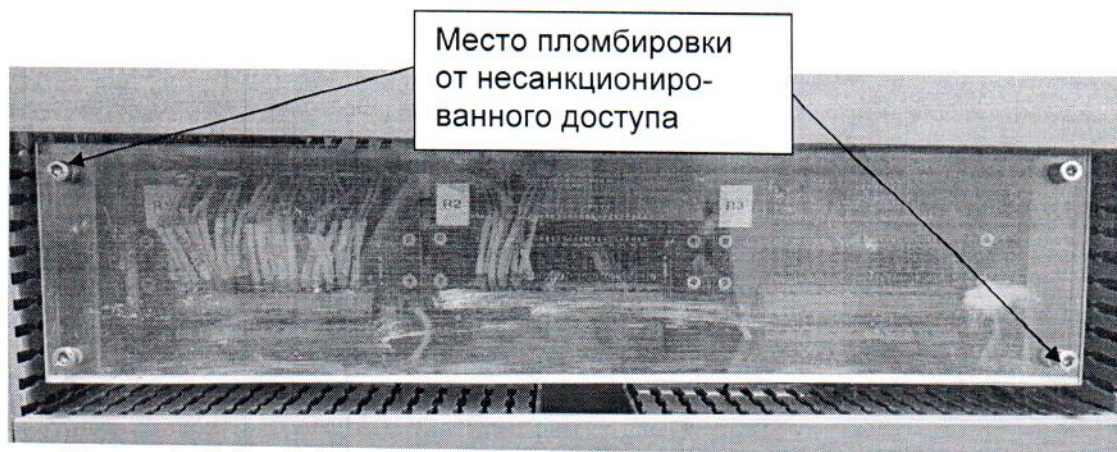
Рисунок 3.3 – Места пломбировки модуля токовых сигналов AIN-R
