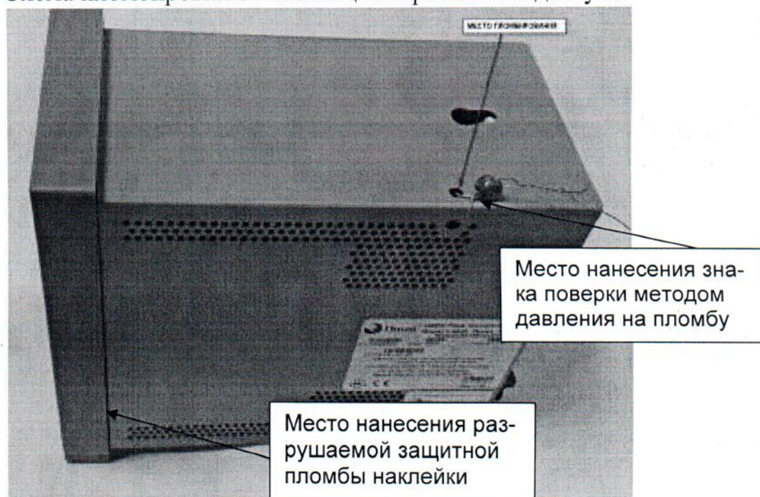
Рисунок 3.1 – Места пломбировки
