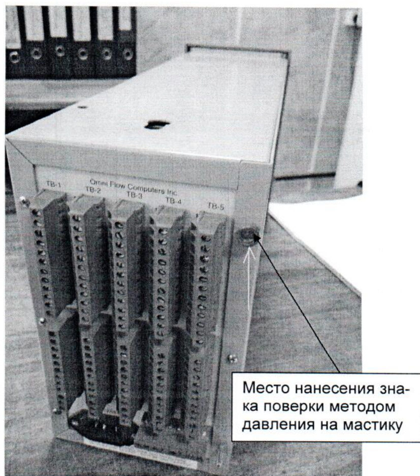
Рисунок 3.2 – Место пломбировки на задней поверхности
