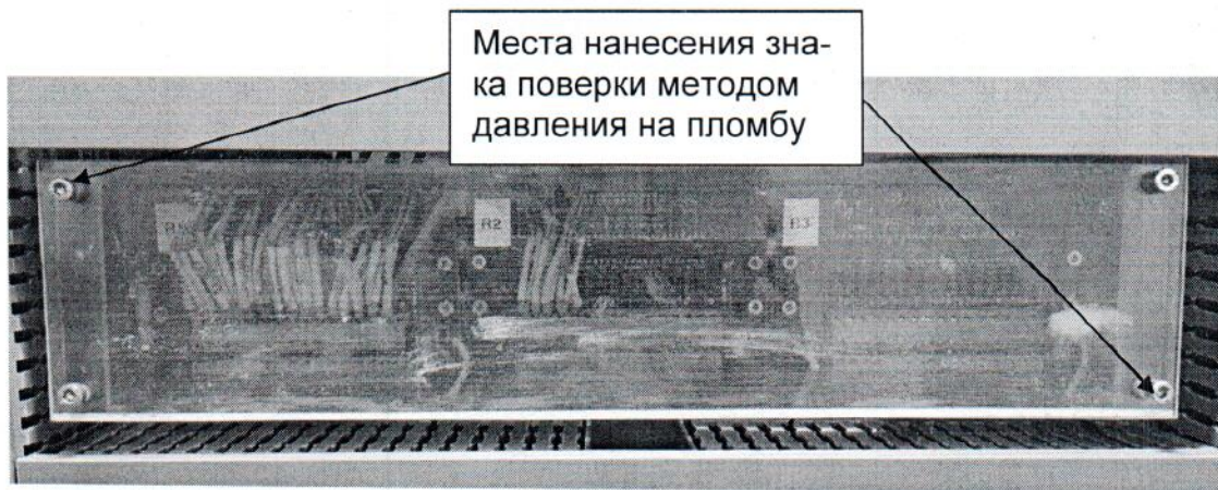
Рисунок 3.3 – Места пломбировки модуля токовых сигналов АИН-Р
