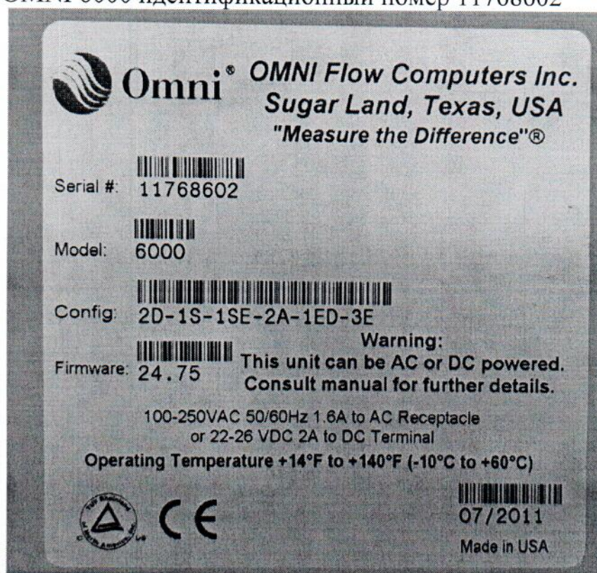
Рисунок 1.2 – Маркировка контроллера измерительно-вычислительного OMNI 6000 идентификационный номер 11768602
