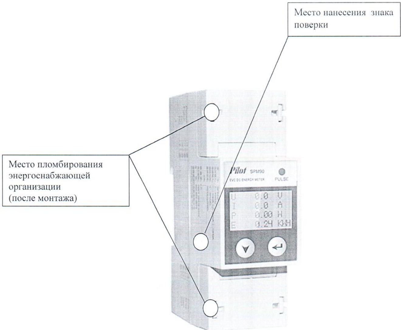
Рисунок 2.1 – Схема (рисунок) с указанием места для нанесения знака(ов) поверки средств измерений и пломбировки от несанкционированного доступа счетчика SPM90 зав. № SPM90-2-2009224490
