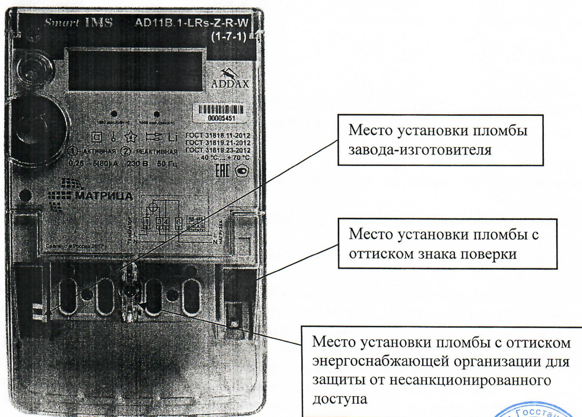
Рисунок 2 - Общий вид счетчика и схема пломбировки от несанкционированного доступа в корпусе типа «классический тонкий», разрушаемом при вскрытии
