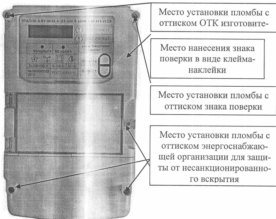
Рисунок А.2. Места установки пломб и нанесения знака поверки для счетчиков в корпусе модификации W32.
