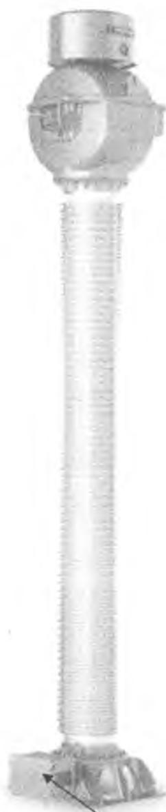
Место нанесения знака поверки в виде клейма-наклейки
