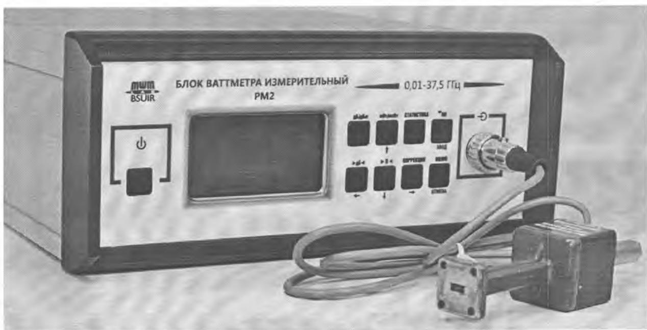
Рисунок 2 – Внешний вид ваттметров поглощаемой мощности СВЧ диапазона РМ 0,01–37,5
