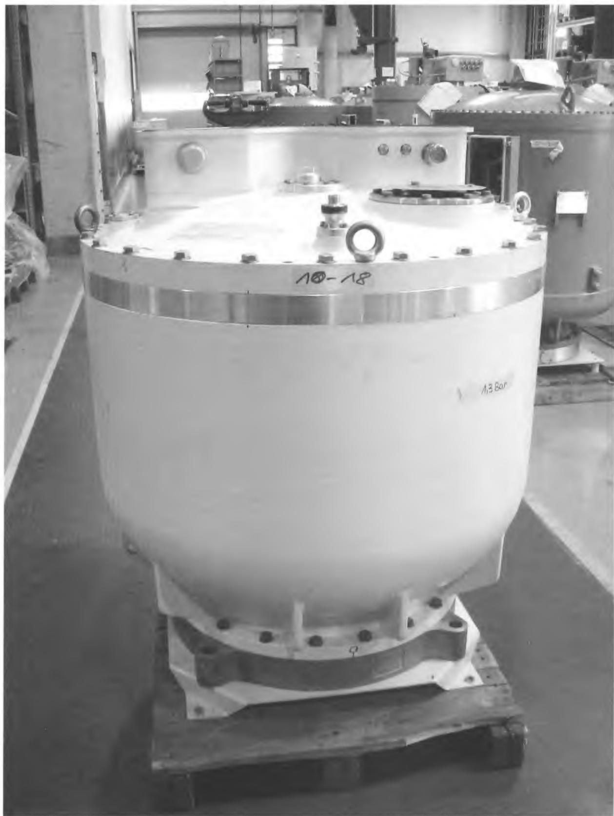
Рисунок 1 – Измерительный трансформатор напряжения
