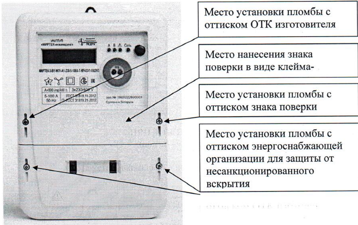
Рисунок А.1. Места установки пломб и нанесения знака поверки.
