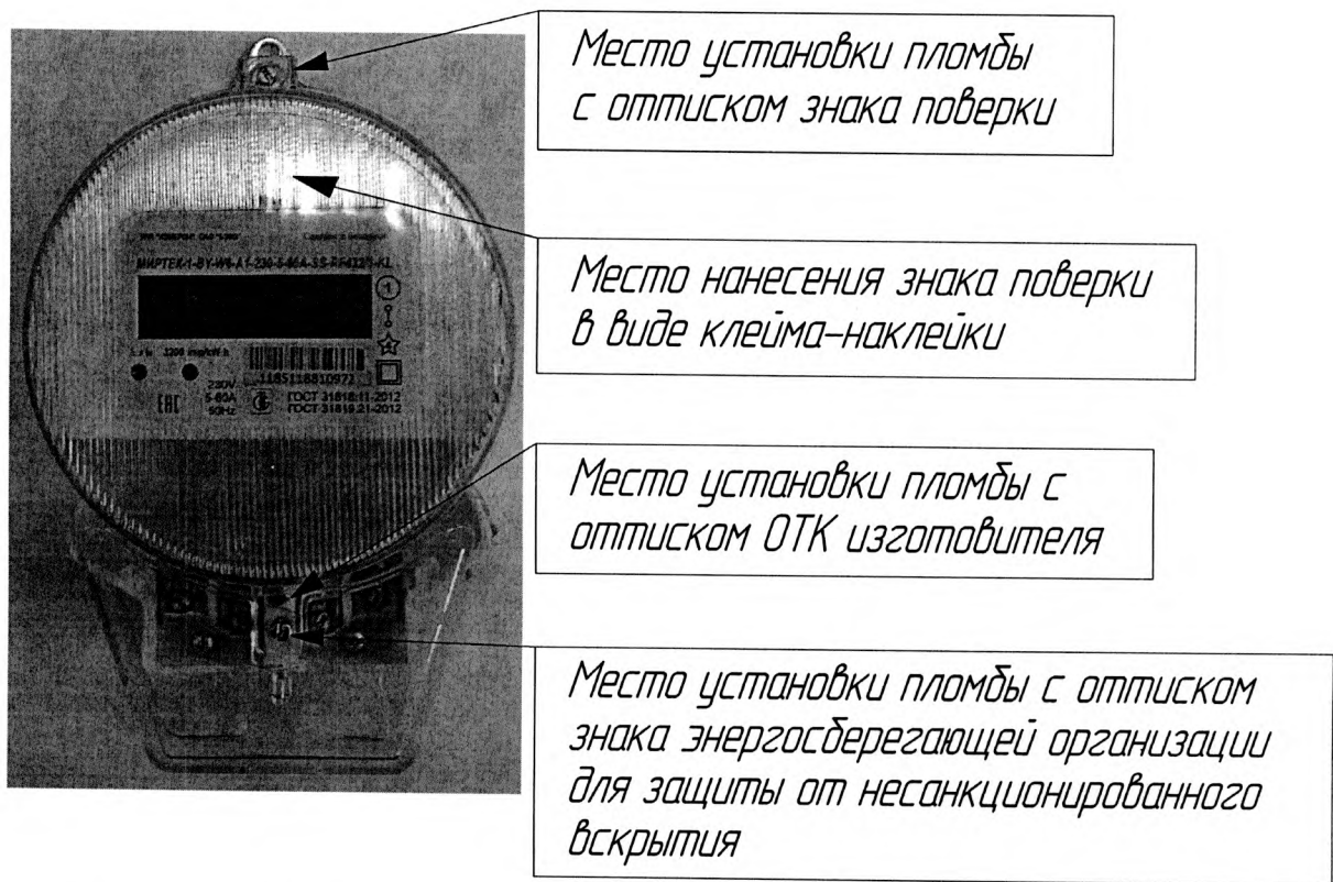
Рисунок А.3 – Места установки пломб и нанесения знака поверки для счетчиков в корпусе модификации W6
