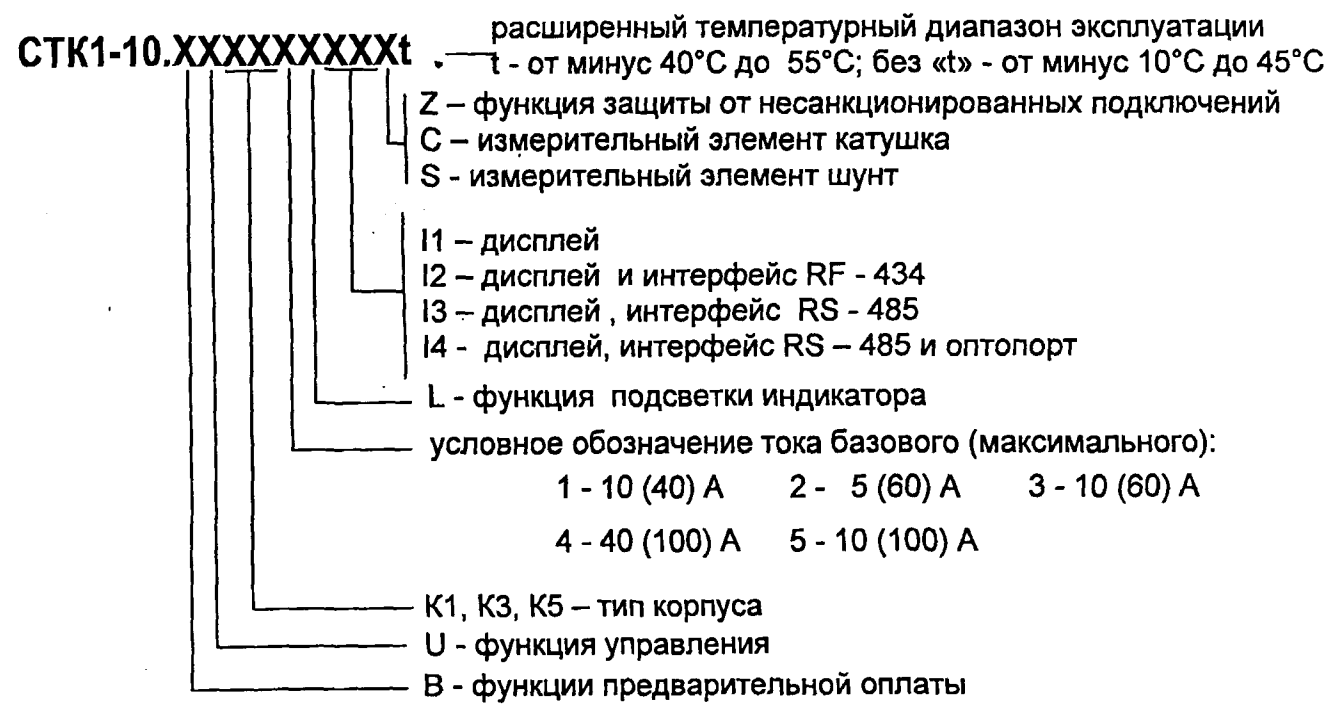
Рисунок 1 – Схема построения обозначения возможных исполнений однофазного счетчика СТК-1
