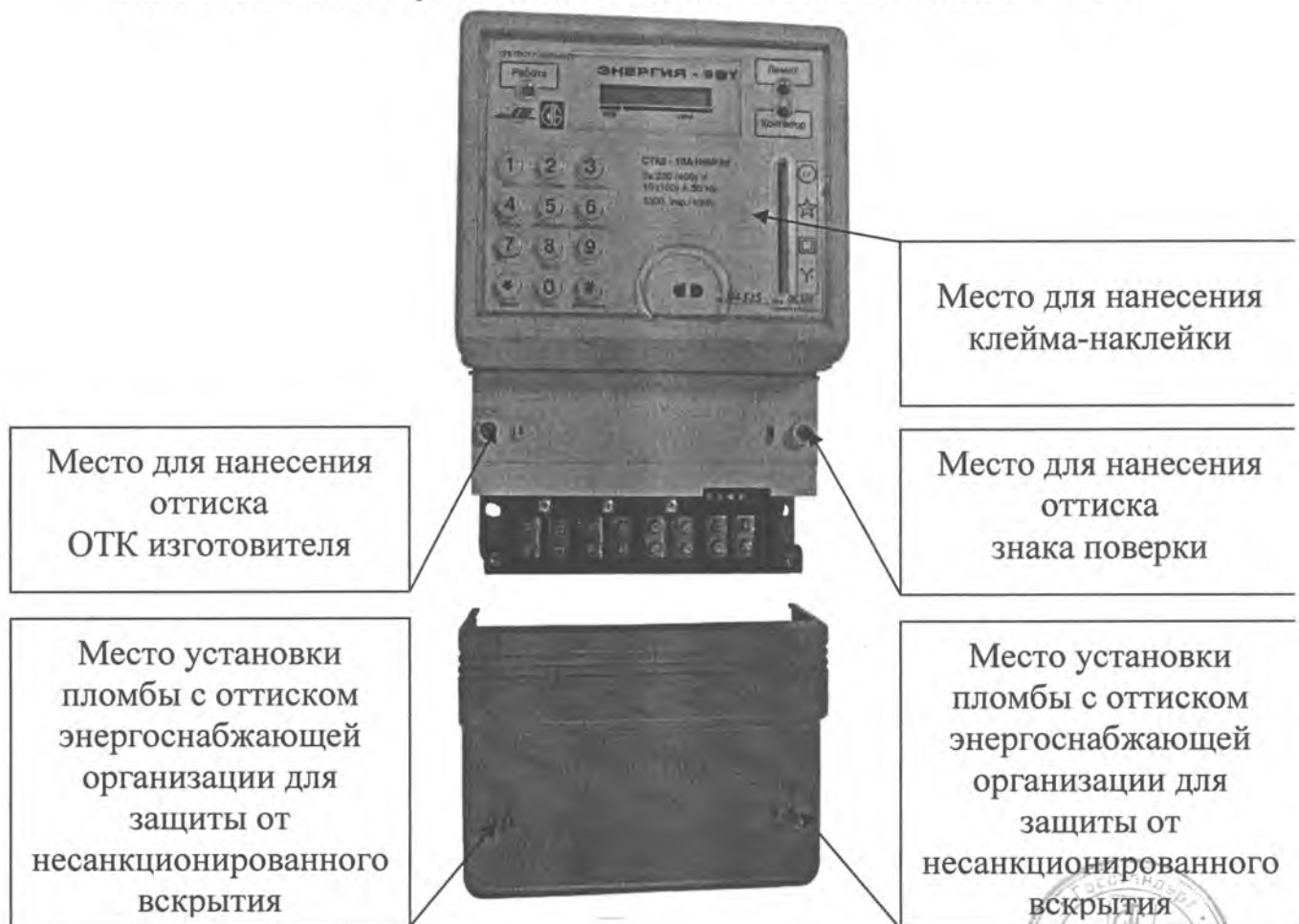
Рисунок А.2 – Места нанесения оттиска знака поверки, клейма-наклейки и установки пломб на счетчик исполнения СТК3
