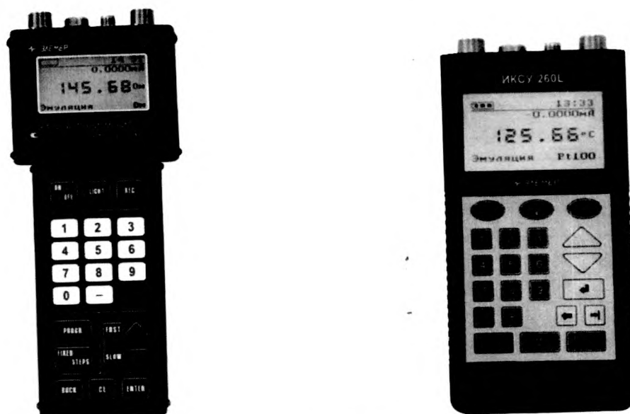
Рисунок 1 – Конструктивные исполнения калибраторов-измерителей унифицированных сигналов эталонных ИКСУ-260
