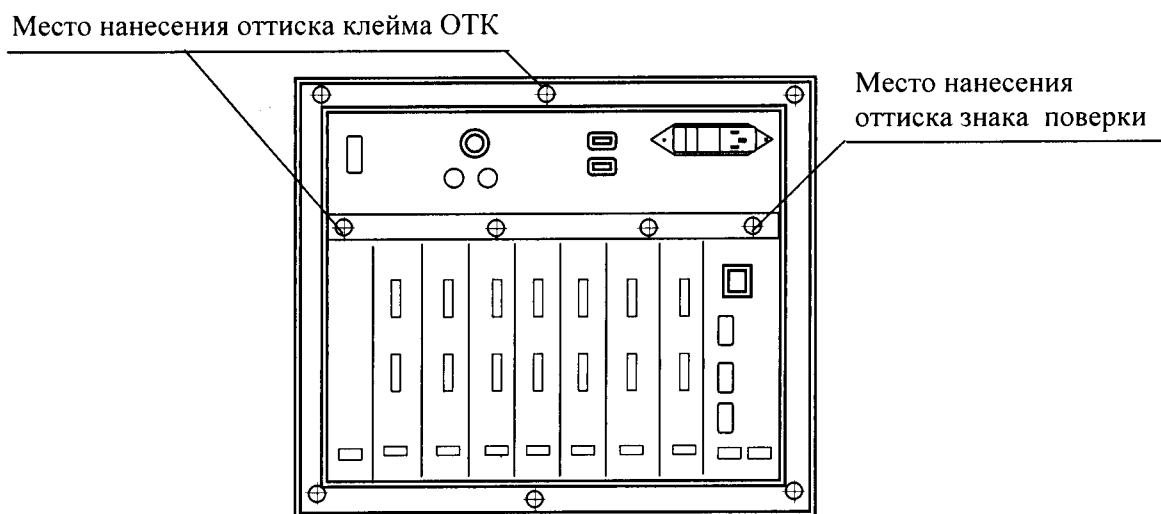
Рисунок А.1 – Место нанесения оттиска знака поверки (задняя панель регистратора)
