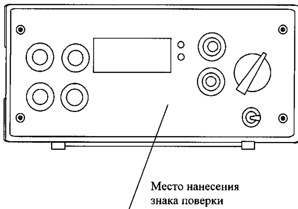
Рисунок А.1 – Передняя панель миллиомметра
