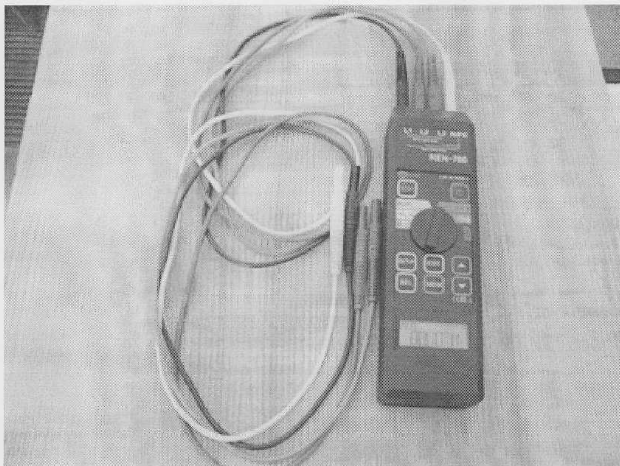
Рисунок 1 – Внешний вид анализатора – регистратора показателей качества электрической энергии с функцией измерения фликера REN-700
