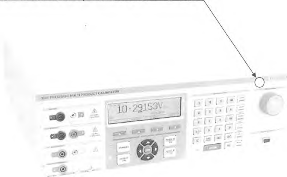
Рисунок А.1 – Место нанесения поверительного клейма-наклейки
