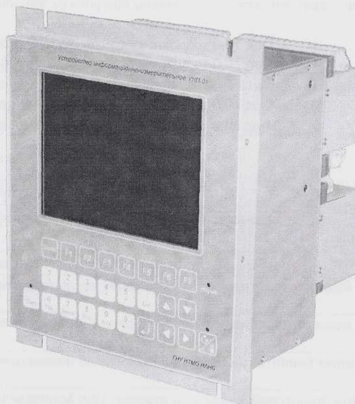
Рисунок 1 - Устройство информационно-измерительное распределенного управления подстанциями и электрической частью станций УИП-01
